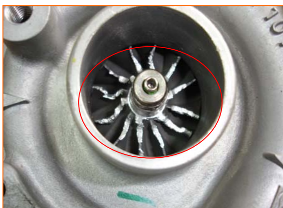
图 6.1 进气叶轮被磨损
