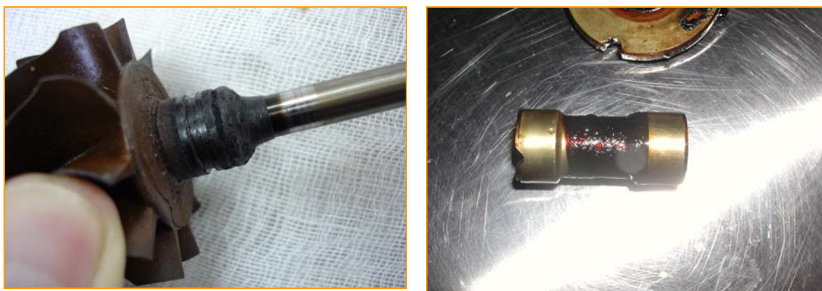
图 1.1 有结焦的增压器图片
