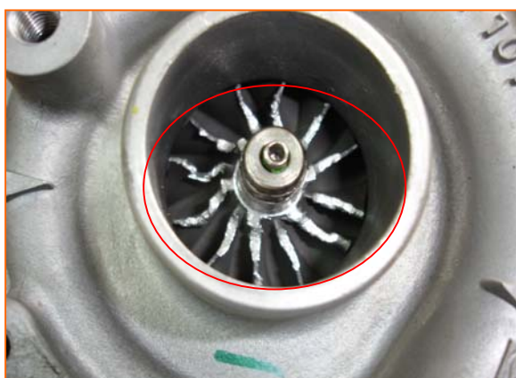
图 6.1 进气叶轮被磨损
