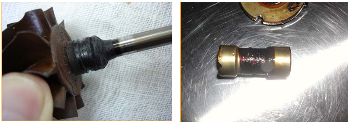
图 1.1 有结焦的增压器图片
