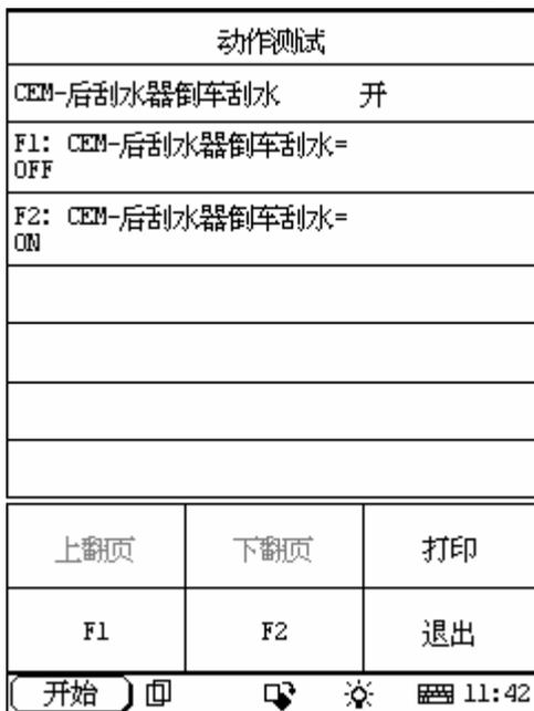
CEM-后刮水器倒车刮水 开 是此时车上的设置，您可根据您的需要，通过编程来改变此设置，可以编程二个选择:
